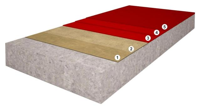
Эпоксидного Основания, 3,0-3,5 мм, Многослойная, Самовыравнивающаяся Система Напольного Покрытия / Интенсивное Движение / Высокая Механическая Устойчивость
